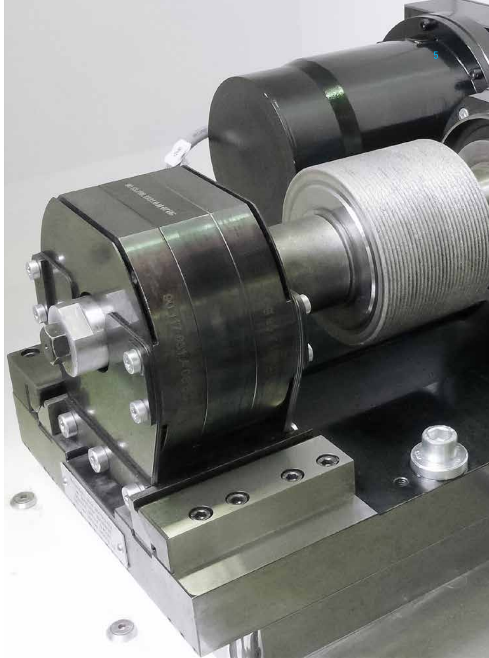
▲ Tischmontiertes Abrichtgerät PA-TL 200S für Diamantprofilrollen bis 200 mm Breite oder mit Universal-Diamantformrollen und Vorprofilierwerkzeug für das bahngesteuerte Abrichten mit Schnellwechseinrichtung für den Rollendorn.
