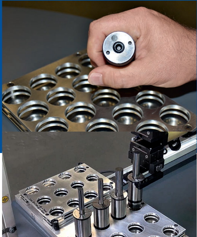
Kundenprojekt: Spannzange (Typ NK) mit RFID-System für das automatisierte Nachschleifen mit verschiedenen Werkzeug- durchmessern innerhalb eines Batches
